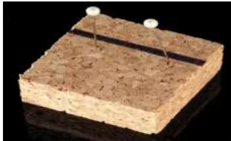
(الشكل 5.18) ألواح ودبابيس الفلين لتركيب عينات LLETZ\LEEP.
